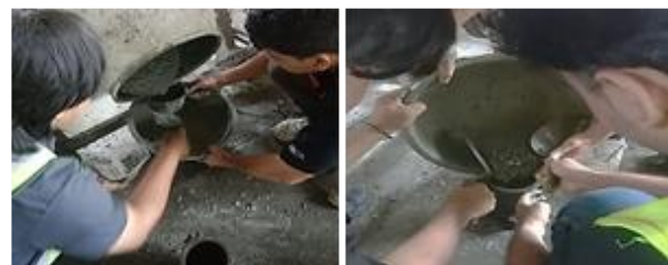
Gambar 5 Proses Penambahan Pelet Enkapsulasi Bakteri pada Benda Uji
