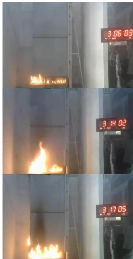
**Gambar 10** Kondisi Awal Pengujian Konfigurasi Ke-2, Menit ke-8, dan Menit Ke-11 Pembakaran
