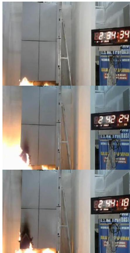
**Gambar 14** Kondisi Awal Pengujian Konfigurasi Ke-2, Menit Ke-8, dan Menit Ke-10
