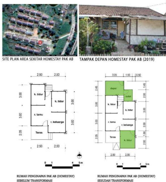
Gambar 12 Denah Awal Penginapan Pak AB (kiri) dan Denah Perubahan Penginapan Pak AB (kanan)
