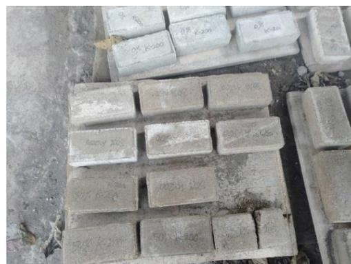
**Gambar 2** Sampel *Paving Block* Hasil Produksi
