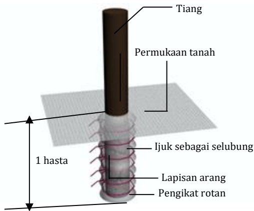
Gambar 1 Sistem Pondasi Rumah Komali
