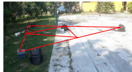
Gambar 8 Konfigurasi Array Segitiga untuk Pengukuran Mikrotremor Array Lapisan Dalam dan Contoh Rekaman Data Microtremor untuk Setiap Array Segitiga Di Sekitar Bendung Walahar
