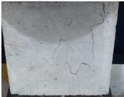
Gambar 6 Pola Kegagalan Benda Uji
