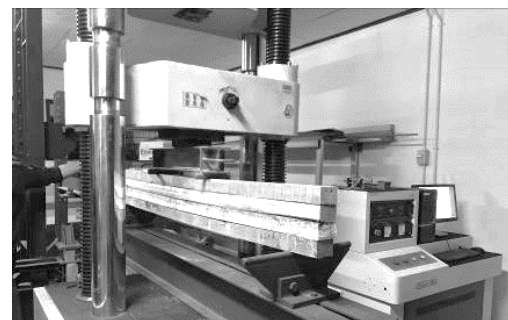
Gambar 10 Proses Pengujian Balok Laminasi Benda Uji.
