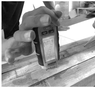
Gambar 7 Proses Pengukuran Kadar Air Pada Lamina Kayu.
