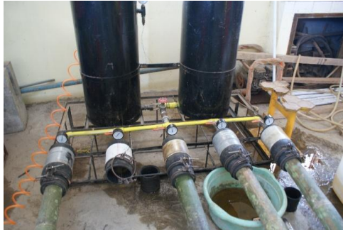
Gambar 1 Proses Pengawetan Bambu Dengan Menggunakan Boron dan Cuka Kayu
