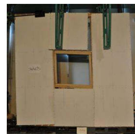
Gambar 21 Kondisi Akhir Pengujian Spesimen Dinding Geser Dengan Bukaan Jendela (SWWOS)
