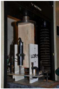
Gambar 4 Spesimen Uji Geser Paku Tunggal Antara LVL dan FCB yang Diikat Oleh Paku N75 Kepala Ganda, Paralel Arah Serat Di Bawah Mesin Uji
