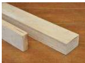
Gambar 1 Kayu LVL yang Digunakan untuk Rangka Dinding Geser
