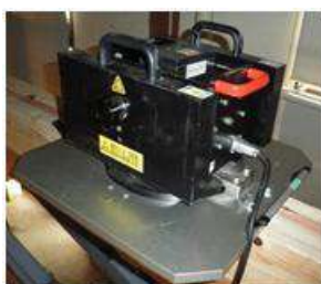
Gambar 6 Mesin Eksitasi Goyang Portabel Tipe DTH-500-30, Buatan Asahi, Jepang
