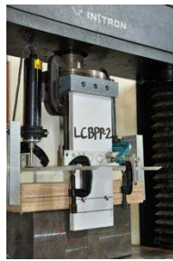
Gambar 5 Spesimen Uji Geser Paku Tunggal Antara LVL dan FCB yang Diikat Oleh Paku N75 Kepala Ganda, Tegak Lurus Arah Serat Di Bawah Mesin Uji
