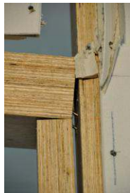
Gambar 25 Panel-B Terlepas Dari Rangka Kayu LVL Spesimen Dinding Geser
