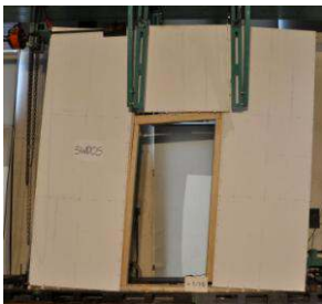
Gambar 24 Kondisi Akhir Pengujian Spesimen Dinding Geser Dengan Bukaannya Pintu (SWDOS)
