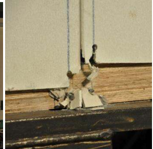
Gambar 19 Panel FCB Terkoyak Dan Terlepas Dari Batang Rangka Kayu LVL
