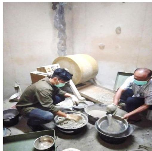
**Gambar 1** Penghalusan Lumpur Menggunakan Mesin Los Angeles
