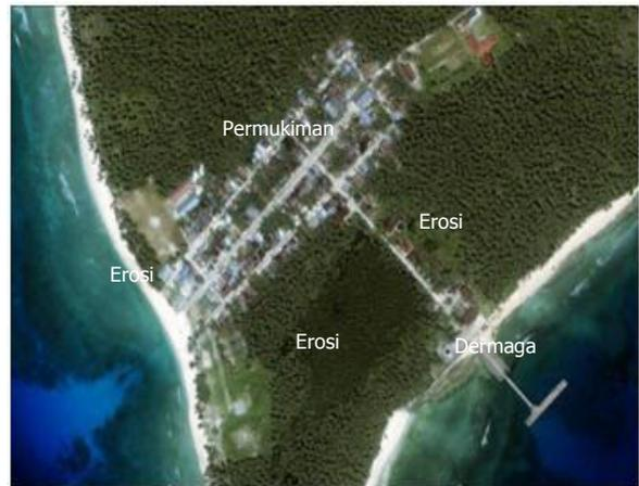
**Gambar 6** Kerusakan (Erosi dan Abrasi) Pantai Kawasan Permukiman Pulau Miangas (Iconos, skala 1:3,500)
