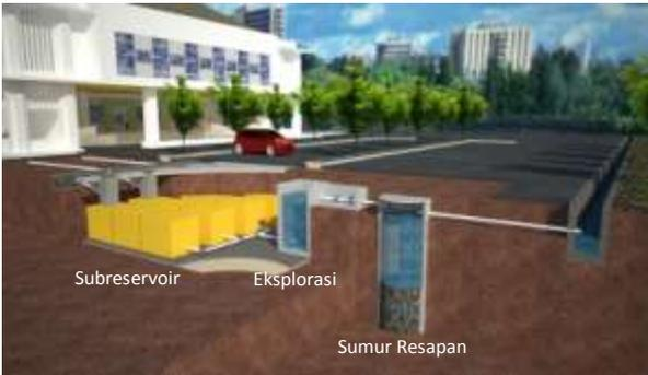
**Gambar 2** Esometrik Subreservoir Air Hujan Pada RTH, tanpa skala (Modifikasi dari Sarbidid, et al, 2011)
